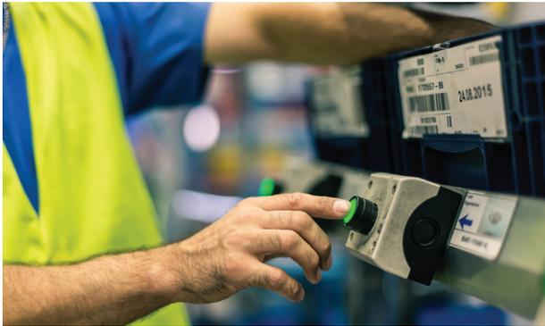
Abb. 2: Entnahme von Modulen über Pick-By-Light
